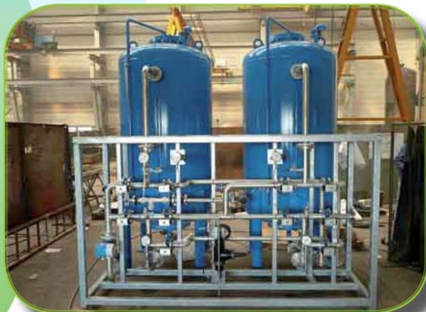
Déferrisation - Filtration Skid Export
